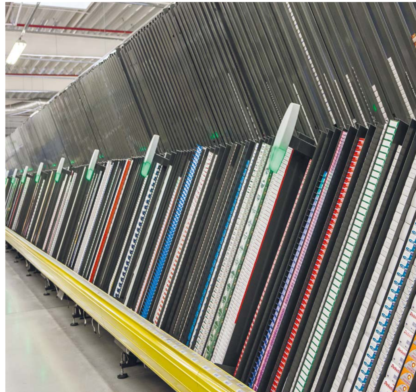
Automat do kompletacji zamówień do aptek w magazynie PGF
